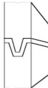
sučevnih spojeva sa žljebom
